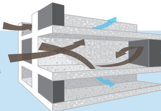
*Les barrières forcent les gaz d'échappement à traverser les cloisons poreuses.*
