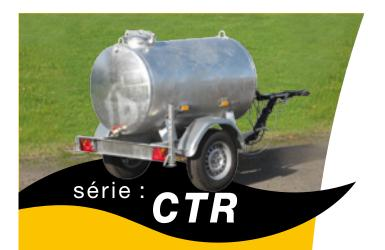
est conçue pour le transport d'eau. Utilisées comme point d'eau fixe ou mobile, elles facilitent les opérations de nettoyage, d'arrosage et autres... De conception simple et robuste, ces remorques citernes sont équipées d'une vanne de vidange arrière, d'un trou d'homme et d'un timon réglable double articulation.
