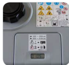
Compteur d'heures et vibrations
