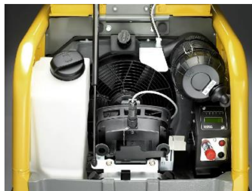
Réservoir grande capacité, facilement accessible, possibilité de contrôler le niveau de remplissage de l'extérieur
