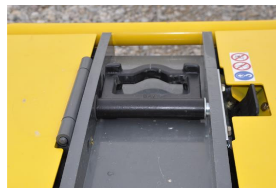
L'anneau de levage peut être déplacé latéralement puis rabattu dans une position neutre
